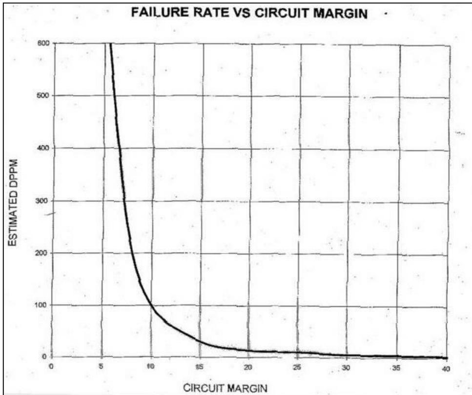
When necessary to vary the PCB's Circuit Margin, we need to consider the PCB factors generating the negative resistance. If we look at the negative resistance, we can say 如果需要改变 PCB 的电路 Margin, 我们需要考虑产生负性阻抗的 PCB 的一些因素。如果我们看看负性阻抗, 我们可以说:
