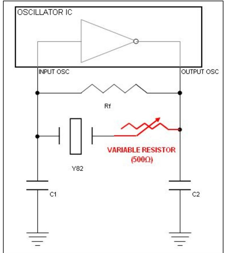
The crystal used MUST be an average crystal. Do NOT test a defective, questionable, or unknown crystal for this negative resistance test. 使用必须是一个一般的晶体。不要在测试负性阻抗时使用一个不良的, 有问题的或未知的晶体。
